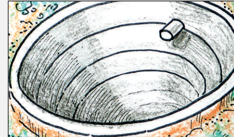
సిమెంట్ రింగులతో గోడ కట్టడం
